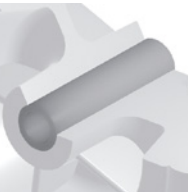
Gleitlager für kurze Distanzen.
